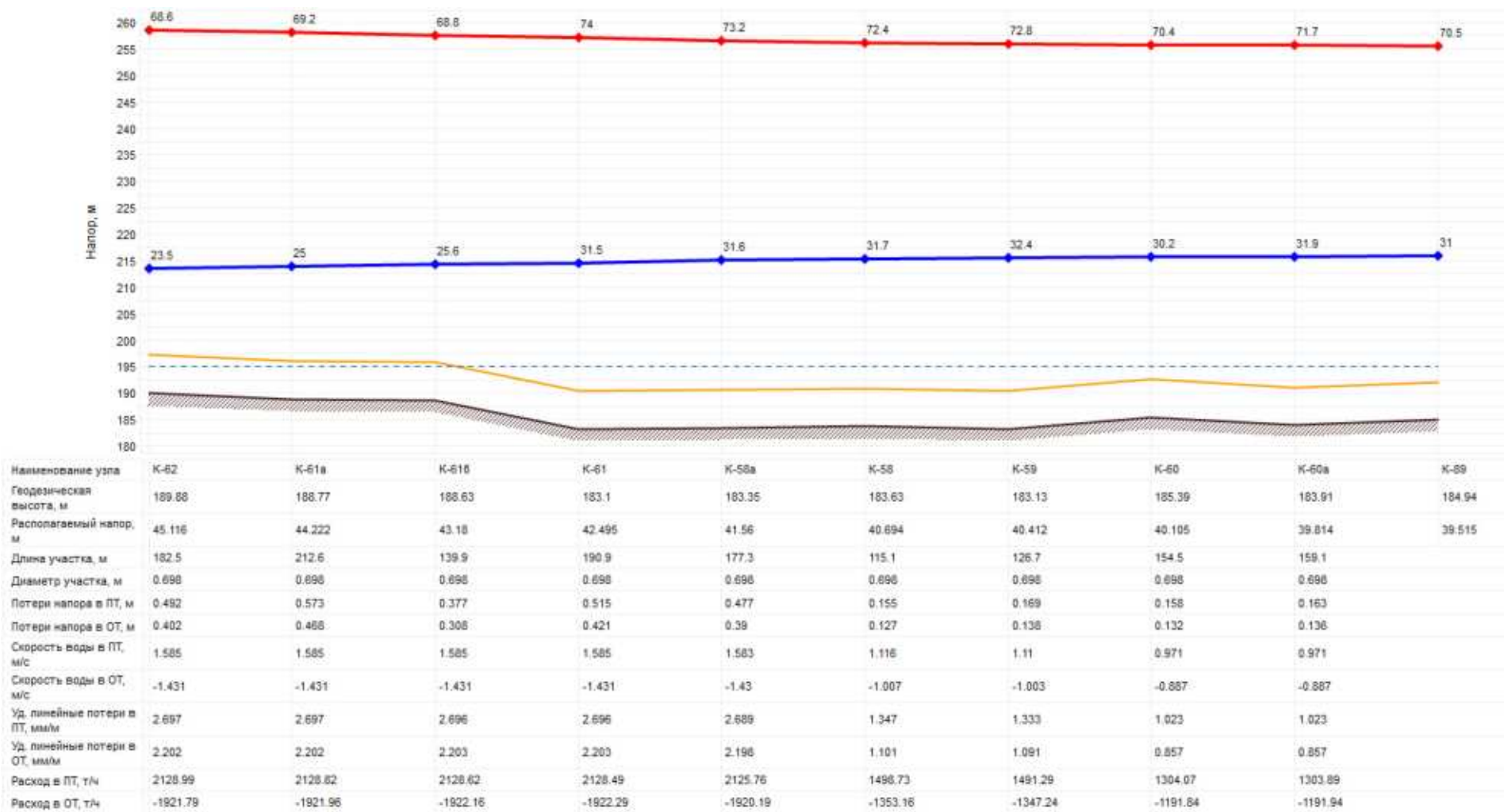
Рисунок 6 – Пьезометрический график участка тепловой сети Ду700 мм по ул. Королева после подключения перспективных нагрузок и ее реконструкции
